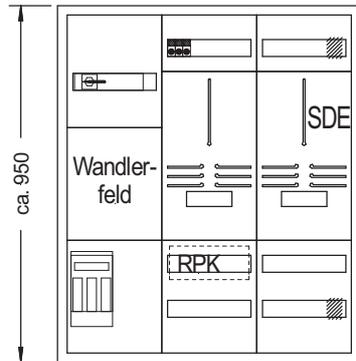
Einkundenwandlermessung, optional mit PV-Anlage ≤ 30 kW (Selbstverbrauch)
