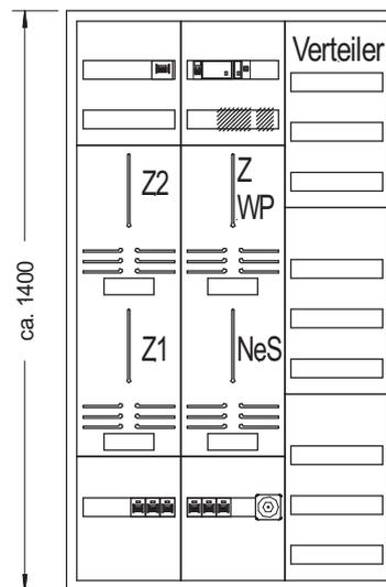
Mehrkundenanlage ohne Erzeugungsanlagen und unterbrechbare Verbrauchseinrichtungen
