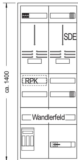
Einkundenwandlermessung, Wandlerplatz in Standverteiler integriert, Speisung der Hauptleitung über Doppelkabel
